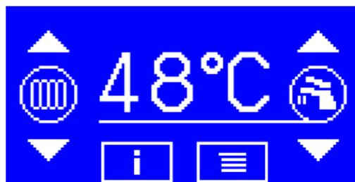
**ОТОБРАЖЕНИЕ ТЕМП. ВОДЫ ОТОПЛЕНИЯ**
