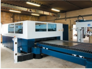
Разделение листового металла при помощи лазера
