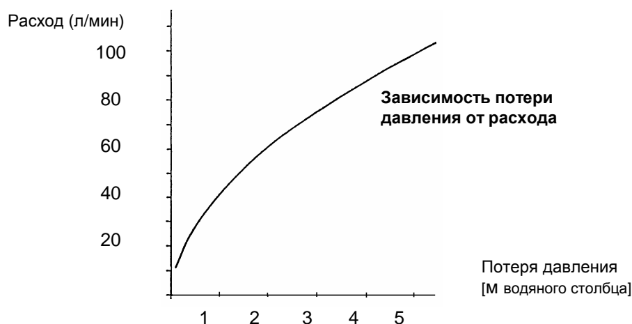
Рис. 14 Характеристика трехходового клапана Honeywell V 4044F
