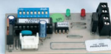
Интерфейс IU 05 обеспечивает коммуникацию регулятора Therm RC 03 с управляющим котлом в каскаде
